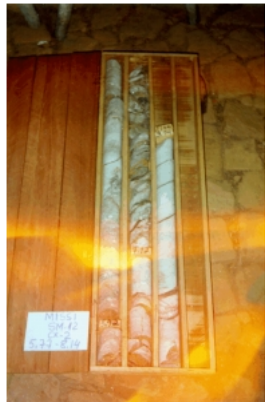
FOTO 06 - SM-12-CAIXA- 02 TRECHO:5,77m a 8,14m
